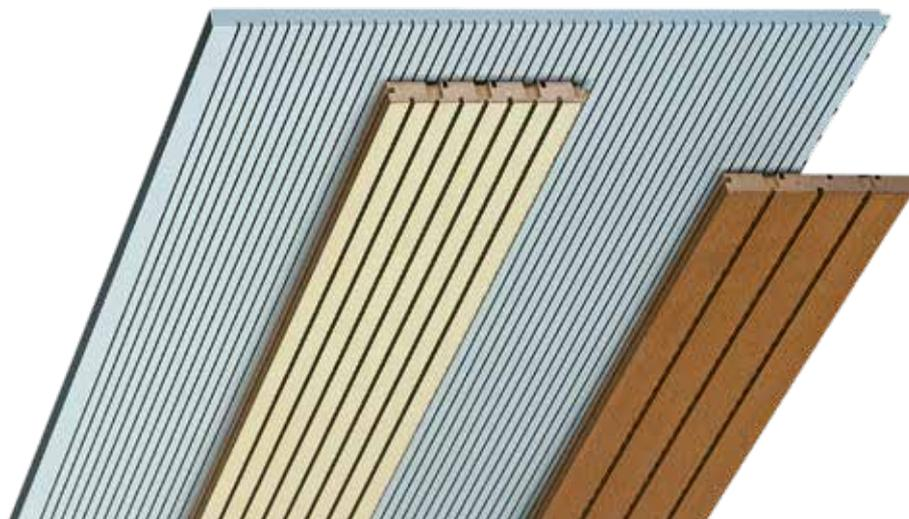
Topakustik Classic ist das raffinierte Akustiksystem für Wand- und Deckenbekleidungen. Verschiedene Rillungen stehen zur Wahl. Dank der rückseitigen Perforation in der Bienenwabenstruktur behält die Trägerplatte ihre Stabilität weitgehend. Anschnitte beispielsweise sind überall möglich.
