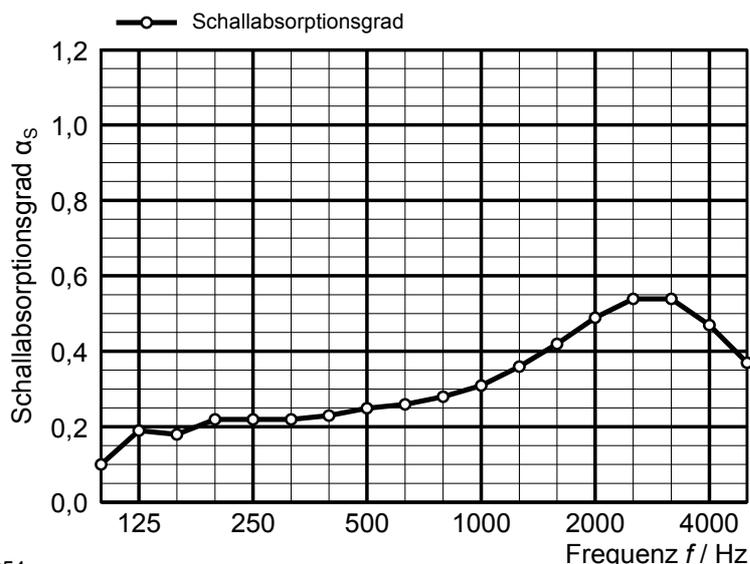
$\alpha_s$  Schallabsorptionsgrad nach ISO 354
